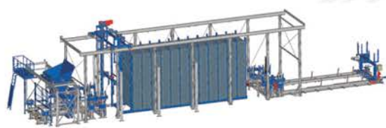
Poste de fabrication Empileur /Dépileur Zone de stockage Empileur /Dépileur Palettisation
